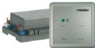
LEGIC Erfassungseinheit mit intelligentem Türmanager DML2
